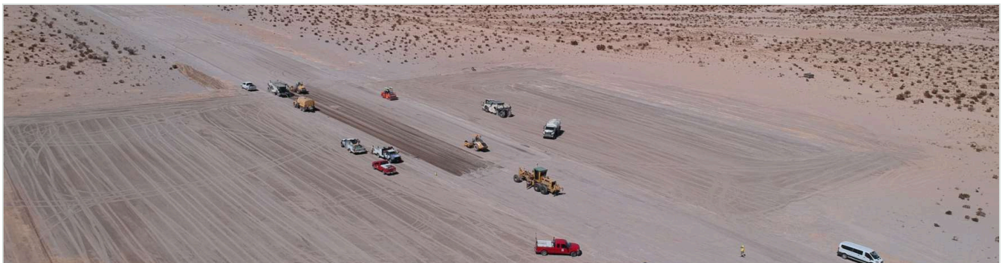
Aérodrome militaire de l'ALZ Sandhill, 29 Palms : couche LL-TEQ comme surface de roulement finale sous charges d'aéronefs.
